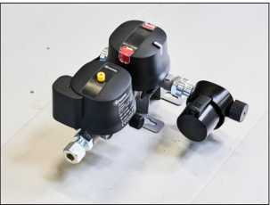
DuoControl – automatische Gasumschaltung mit Crashsensor, der die Gaszufuhr bei einer Kollision von 3,5 G unterbricht. Das System ist europaweit für den Gasbetrieb während der Fahrt zugelassen.
