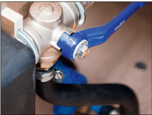
Direktabfluss – Bypass für den Abwassertank (nicht für Safir 600 TDL)
