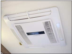
Klimaanlage – Dometic Fresh Jet FJ2600 (serienmäßig im Imperial)
