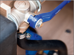
Direkte afløb – afledning til spildevandstank (ikke Royal 600 TDL, standard Imperial)
