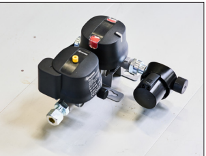
DuoControl – automaattinen kaasupullonvaihtaja törmäysanturilla, joka katkaisee nestekaasun syötön 3,5 G:n törmäyksessä. Järjestelmä on hyväksytty nestekaasun käyttöön ajon aikana koko Euroopassa.
