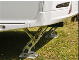
E&P LevelC -hydraulinen tukijalkajärjestelmä
