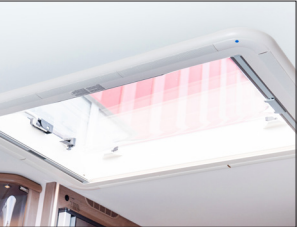
Kattoluukku Heki II (ei Estate)
