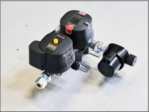
DuoControl – coupure automatique de gaz avec capteur d'impact coupant l'alimentation en gaz en cas de collision à 3,5G. Ce système est homologué pour une utilisation avec le gaz en conduite sur l'ensemble du territoire européen.
