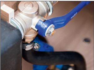
Direkteavløp – forbikobling av gråvannstank (ikke Safir 600 TDL)
