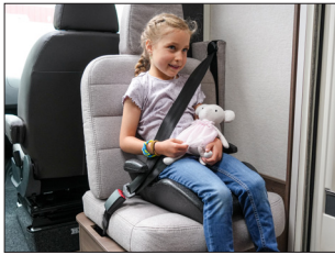
5. Sitzplatz – rückwärtsgerichtet hinter der Aufbautür mit Dreipunktgurt und ISOFIX. Für folgende Modelle erhältlich: x750 LGB, x810 LT/LGB/LQB, i790 LGB/LQB, i830 LGB/LQB, TRAQ i830 LGB/LQB
