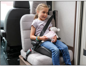
5. seleplads – bagudvendt inden for døren med trepunktssæle og Isofix. Gælder følgende modeller: x750 LGB, x810 LT/LGB/LQB, i790 LGB/LQB, i830 LGB/LQB, TRAQ i830 LGB/LQB
