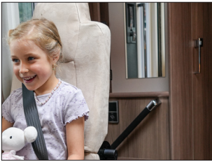
5. seleplads – sammenklappelig, fremadvendt inden for døren med trepunktssæle og Isofix. Gælder følgende modeller: x750 LXL, x810 LXL, x910 LQB, i880 LGB/LQB, i930 GB/QB
