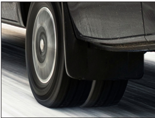
Roues jumelées 4 x 2 et 4 x 4 5 tonnes, environ 850 kg de charge utile supplémentaire, poids total roulant 7 tonnes
