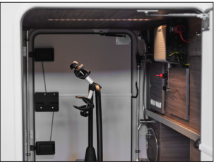
Het praktische fietsenrek van KABE – vervoer en berg je fietsen op in de garage van je camper. Het fietsenrek is uitschuifbaar voor meer gemak en heeft een slimme extra module waarmee je de sturen kunt draaien en zo de ruimte optimaal benut (niet Novum LXL, niet x810 LXL/ LT).
