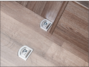
Kinderstoelbevestiging in de vloer
