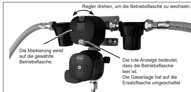
Truma DuoControl ist für zwei Gasflaschen vorgesehen.
