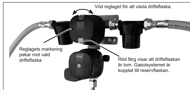
Truma DuoControl är avsedd för två gasolflaskor.
