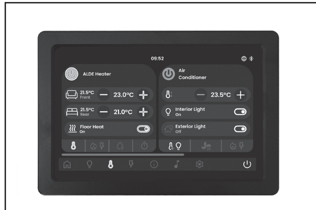
Bedieningspaneel van de camper, menu Verwarming.
