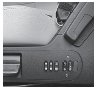
De stoelen zijn voorzien van verwarming en koeling die worden geregeld met de knoppen op de buitenkant van de stoel.
