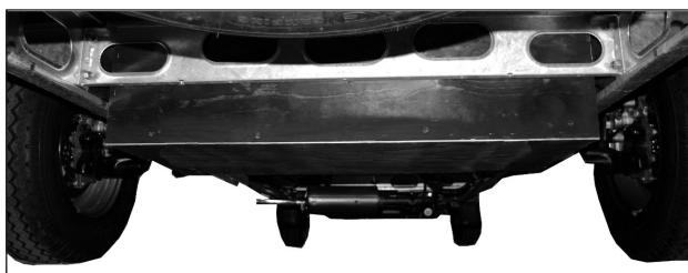
Gråvannstanken er montert ved bobilens bakaksel.
